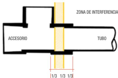
El único sistema para unir Tuberías y Accesorios PAVCO es a base de soldadura líquida que proporciona uniones más seguras y resistentes. Siga las instrucciones:
