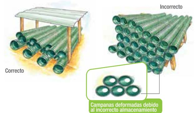
En el almacenamiento, las tuberías deben protegerse de los rayos del sol, colocándolas bajo una cubierta que no permita el paso de la luz directa, que tenga suficiente ventilación y apilándolas siempre a una altura no superior a 1.50 m.
